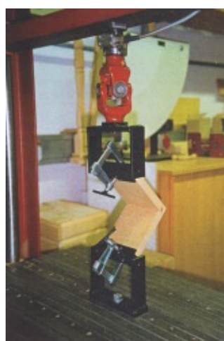
Schenkelbelastung auf Druck: Prüfkörperform 3 Buche verleimt - Dübelverbindung
